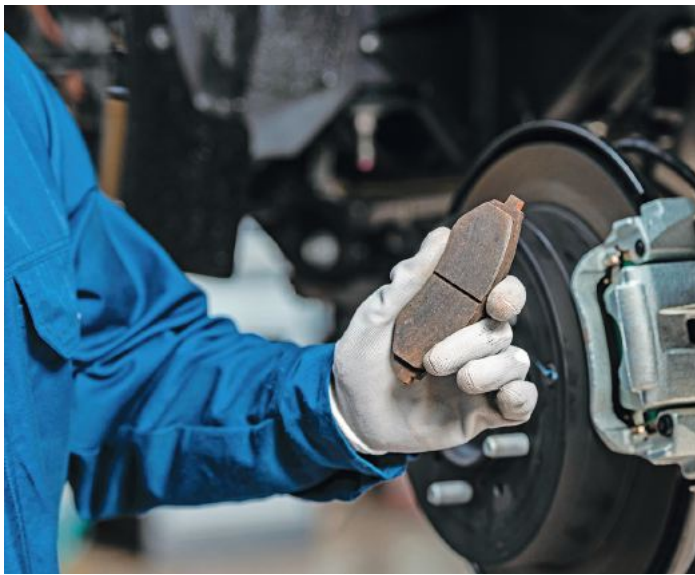
Alle sicherheitstechnischen Bauteile am Fahrzeug sollten von einem Fachmann in Augenschein genommen werden. Dazu gehören auch die Bremsbeläge; diese sollten wie in diesem Fall dringend ausgetauscht werden.
